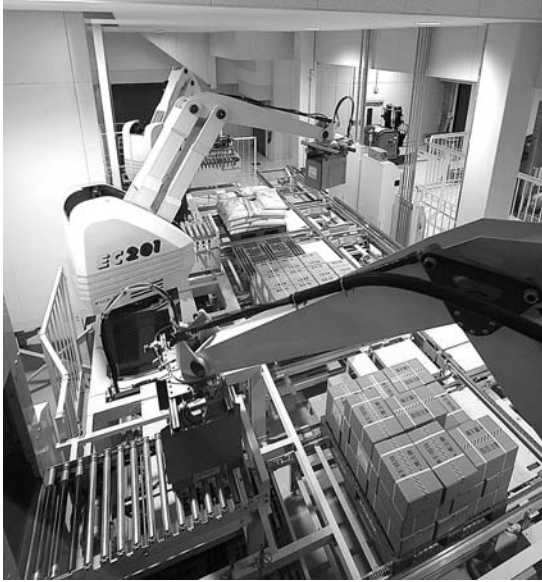
包装された製品は、ロボットが設定された段積みパターンでパレットに積み込む
