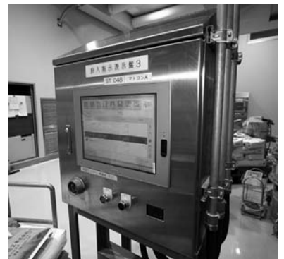
手作業で原料を仕込む際の投入指示表示盤。タッチパネル方式で簡単に選択できる
