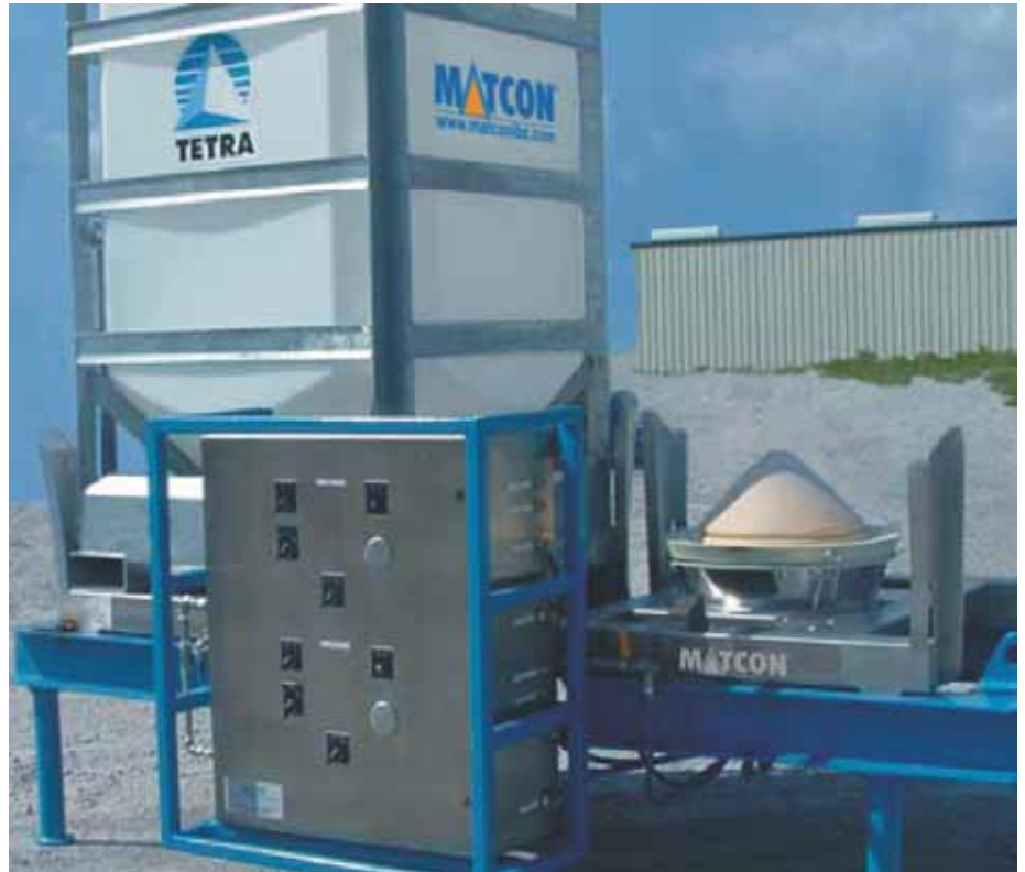
TETRA社の新しいIDeflo DE 配送システムに組み込まれた マトコンIBCとコーンバルブ排出ステーション
