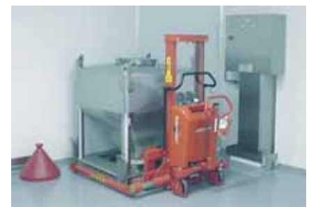
排出ステーションへのIBC搭載
