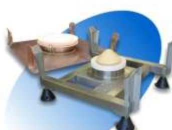
Station de Déchargement Conteneur
